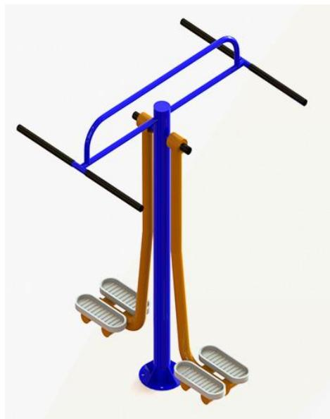
Fabricado com tubos de aço carbono de 1", 2", 3 ½", 4" e tubo retangular 50x30mm, espessura do aço de 2mm a 3mm, pedaleira em alumínio e pintura eletrostática à pó de alta resistência, 100% Poliéster, tampões em aço para proteção dos rolamentos, plaquetas em alumínio com especificação dos músculos trabalhados. Parafusos e porcas antioxidantes.
