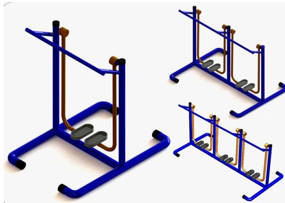
Fabricado com tubos de aço carbono de 1", 1 ¼" e 2", espessura do aço de 2mm a 3mm, pedaleira em alumínio e pintura eletrostática à pó de alta resistência, 100% Poliéster, tampões em aço para proteção dos rolamentos, plaquetas em alumínio com especificação dos músculos trabalhados. Parafusos e porcas antioxidantes.
