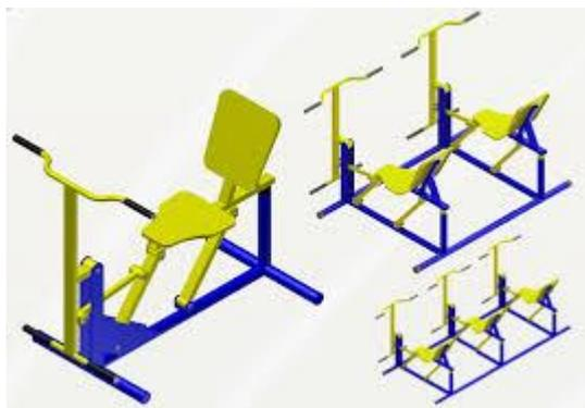
Fabricado com tubos de aço carbono de 1", 1 ¼", 2" e tubo retangular 50x30mm, espessura do aço de 2mm a 3mm, manoplas e apoio dos pés emborrachados, banco anatômico isento de estofamento, pintura eletrostática à pó de alta resistência, 100% Poliéster, tampões em aço para proteção dos rolamentos, plaquetas em alumínio com especificação dos músculos trabalhados. Parafusos e porcas antioxidantes.
