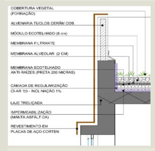
figura 34- detalhe esquemático cobertura vegetal
