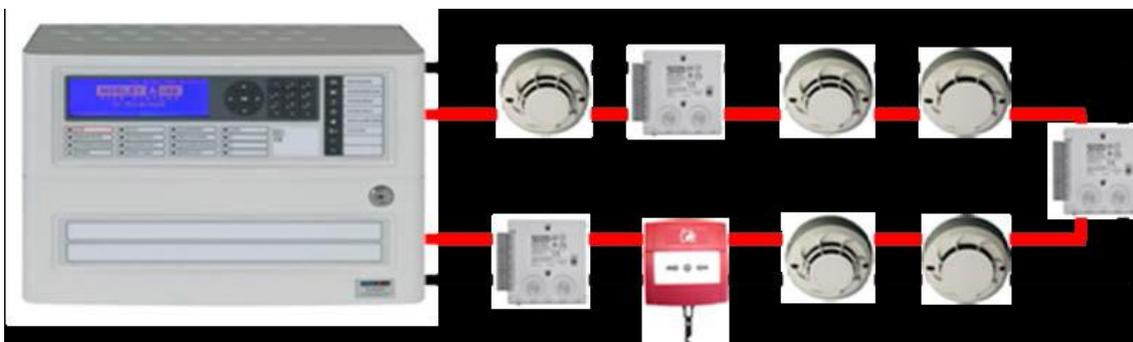
Os detectores deverão ser instalados conforme projeto em todos os ambientes, plateia, balcões, galeira, palco e porão a instalação será externa. Na plateia e demais balcões e galeria, deve ter o cuidado para que a instalação fique o mais discreto possível, a fiação deve percorrer a ferradura de cada andar e atravessar a galeria abaixo do roda forro ate a parede externa da edificação e seguir por rede ate a caixa de passagem e esta conectado a central que esta localizada na sala de administração.
