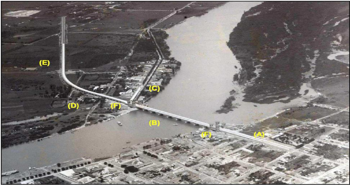
Figura 02: Ponte Internacional Barão de Mauá. (A): Acesso a Jaguarão – lado brasileiro. (B): Ponte Existente Rodoferroviária Barão de Mauá. (C): Viaduto Rodoviário de acesso a Rio Branco. (D): Viaduto Rodoviário de acesso a Coxilha – obras a cargo da República Oriental do Uruguai. (E): Viaduto rodoferroviário da Passagem Paysandú – obras a cargo da República Oriental do Uruguai. (F): Prédios Fiscais.
