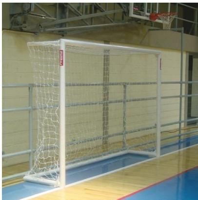
Será instalado 1(um) par de traves (goleiras) para futsal modelo oficial, medindo internamente 3,00 x 2,00 m em tubo de aço galvanizado 3" com requadro inteiriço de 1" (para caimento da rede), a base contorno da goleira que serve para fixar a rede deverá ter contrapeso, mediante preenchimento da seção interna para a estabilidade da goleira, evitando o risco de tombamento;
