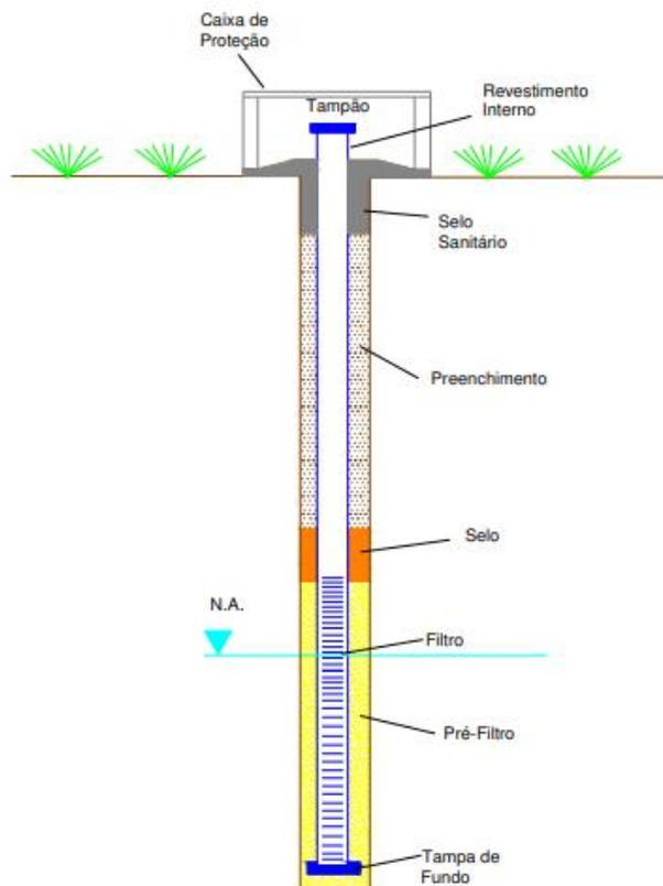
**Figura 01.** Esquema de construção de um poço de monitoramento. (Ernesto Massayoshi Sumib – Dissertação Mestrado)
