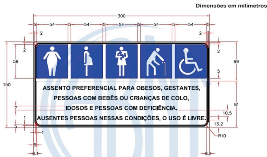
Figura 1- Sinalização assentos preferenciais.
