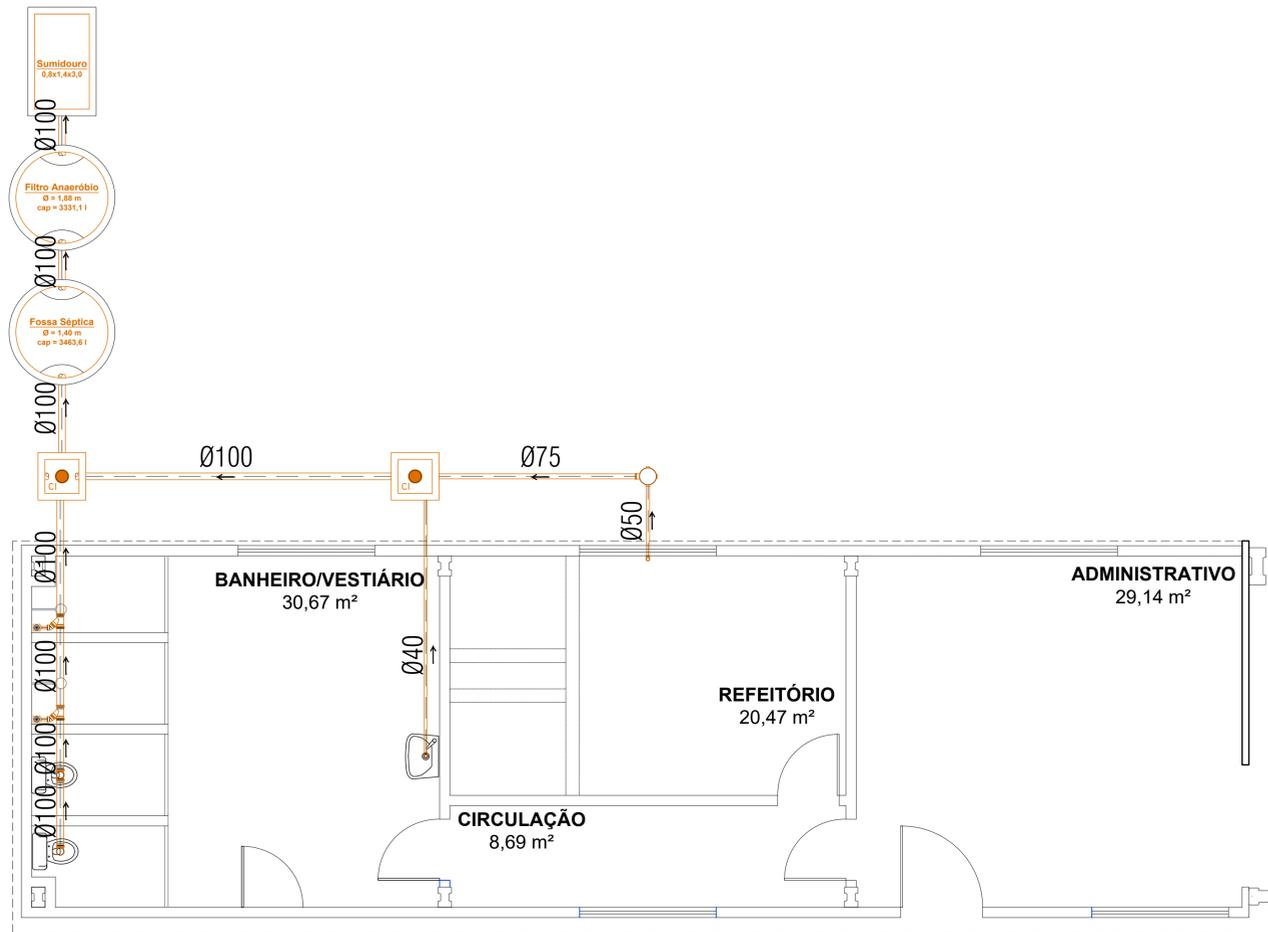
INSTALAÇÃO SANITÁRIA - PLANTA BAIXA
