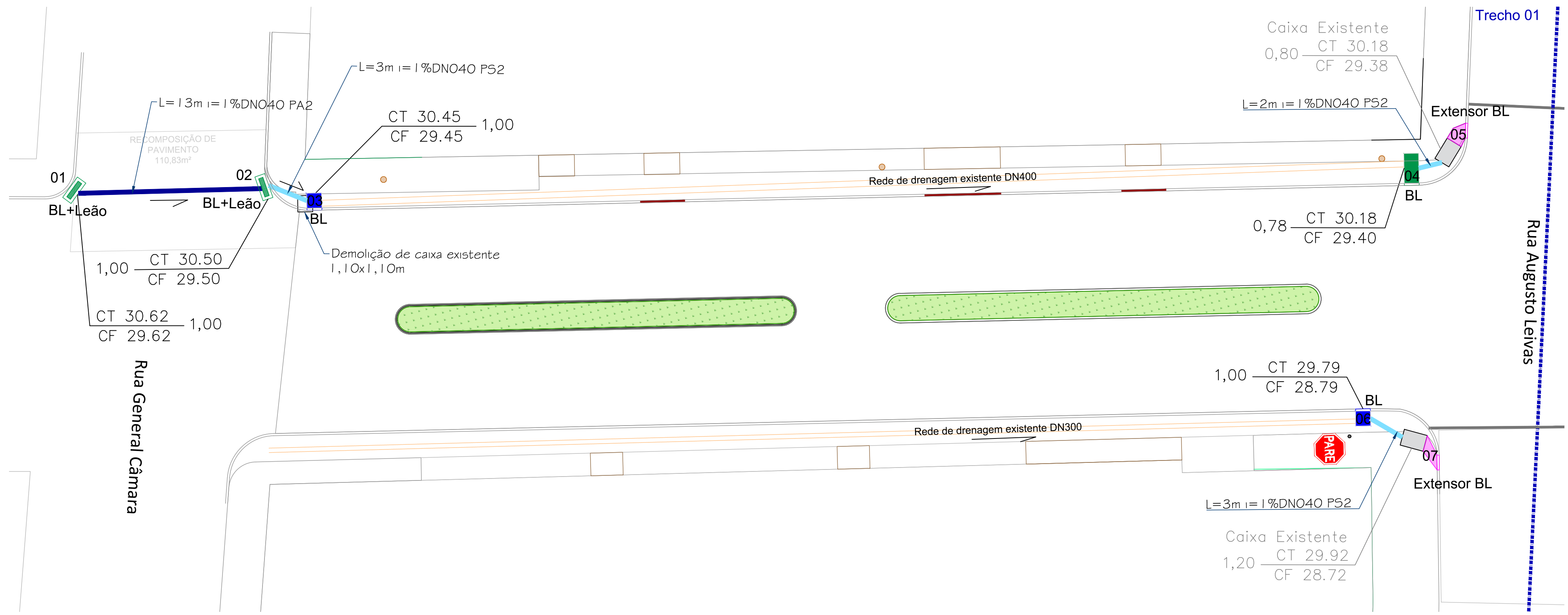
Projeto de Drenagem - Rua 7 de abril entre as ruas General Câmara e Augusto Leivas - Trecho 01 ESC: 1:200
