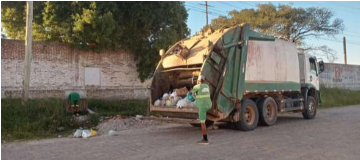
Figura 31. Caminhão compactador realizando a coleta manual.
