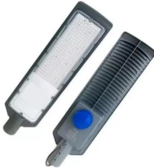
A Luminária Pública tipo pétala a ser instalada nos dois postes do entroncamento da Av. 27 de Janeiro e Rodovia BR116, será com tecnologia LED de alta eficiência, potência 150w, com relé fotocélula integrada, temperatura da luz branca fria, (6000-6500k), ângulo de abertura em torno 120°, índice de proteção acima de IP66, material do corpo da luminária em alumínio com pintura na cor cinza.
