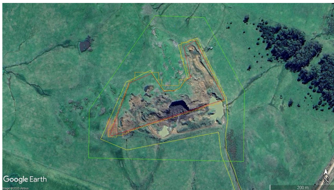
Figura 2 - Imagem de satélite da frente de lavra da pedreira municipal de Jaguarão, com destaque para a área ativa de extração e suas poligonais.
